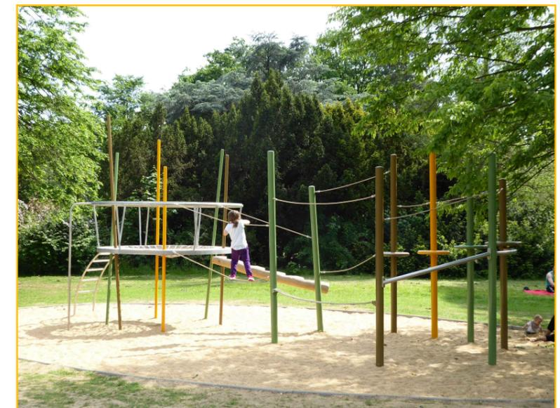
Maximale freie Fallhöhe des Gerätes: 1,70m
