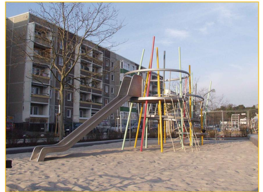
Maximale freie Fallhöhe des Gerätes: 1,80m
